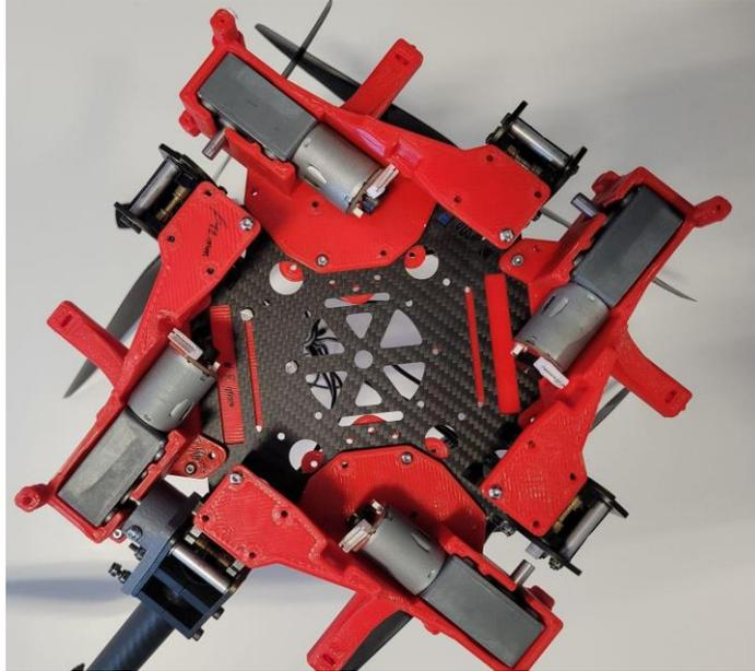
Figure 23 : Structure du drone assemblée, avec les supports moteur
