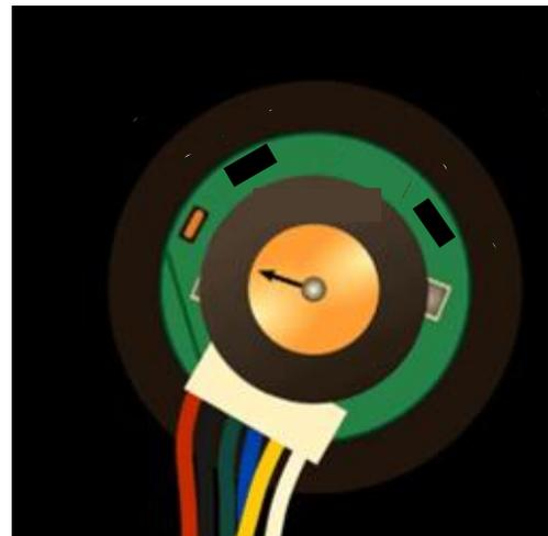
Figure 41 : Représentation d'un encodeur
